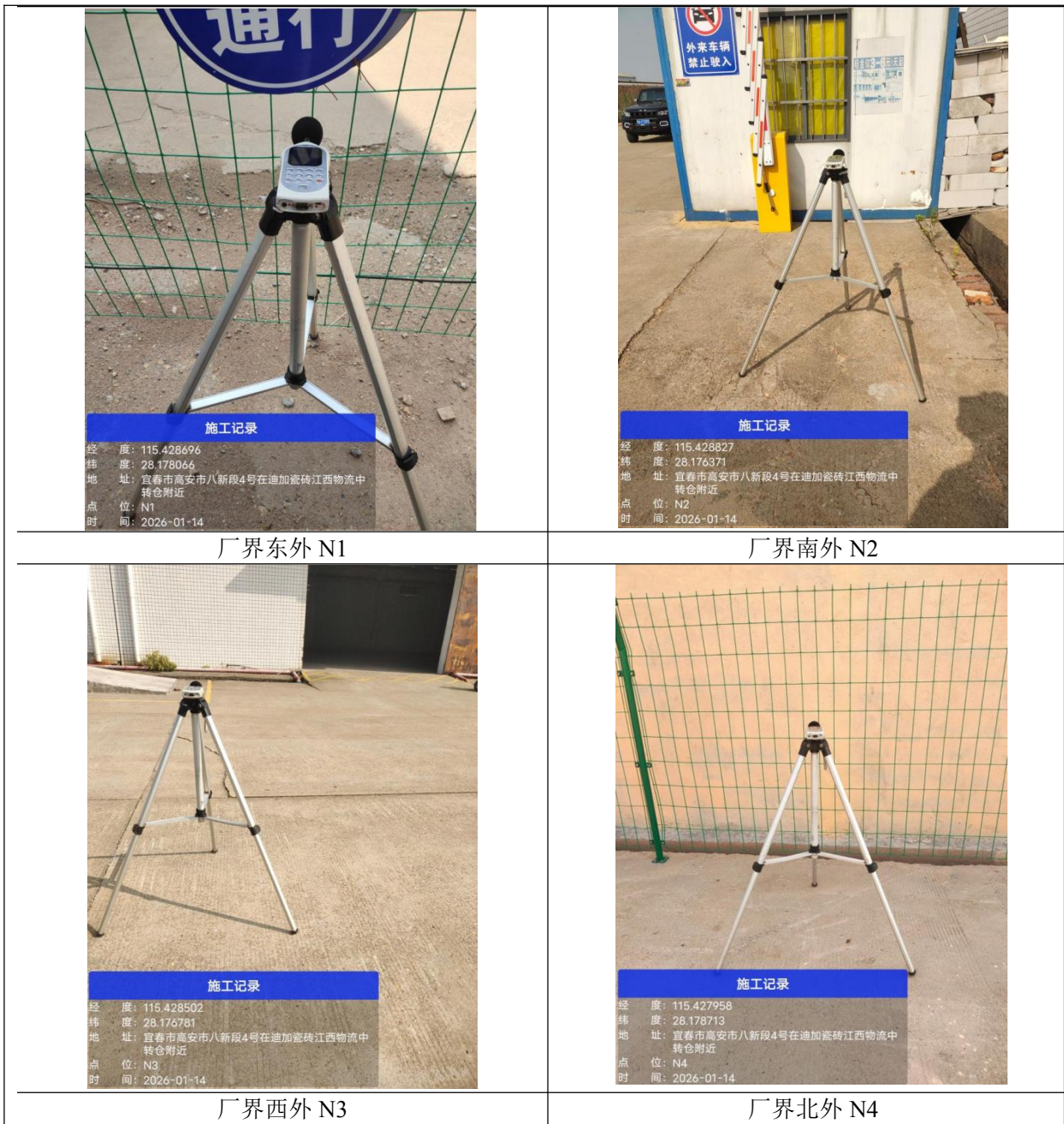
图6-3 厂界噪声现场采样照片
